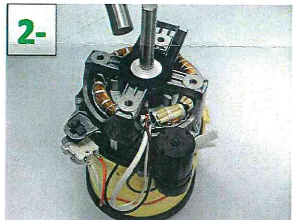
Toujours utiliser un tube (Øint 16 0/+2) pour enfoncer le déflecteur – Always use a tube (internal Ø16 0/+2mm) to push the deflector
