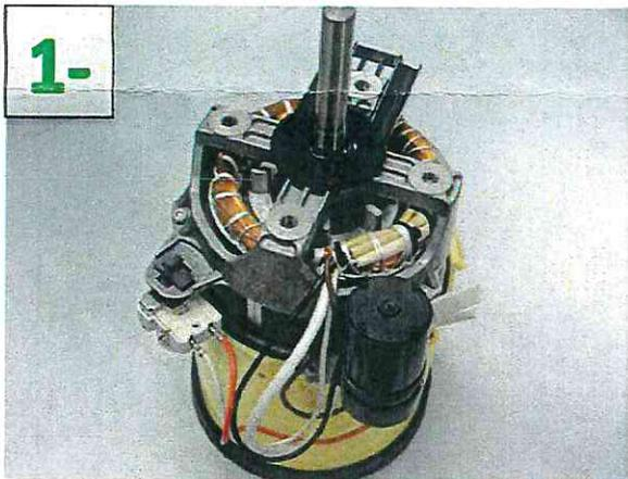
Orienter les drains à l'opposé des fils moteur pour la réf 39271 – For ref 39271, direct the drain towards the opposite of motor leads (wires)
